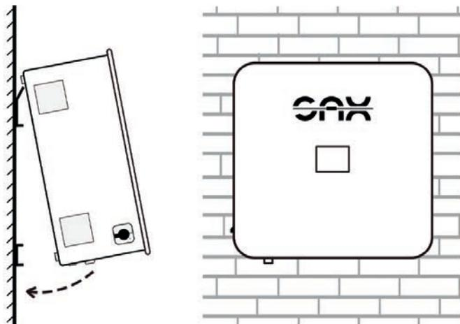
4. Speicher mit zwei Personen einhängen und die Sicherheitschrauben an der Unterseite der Wandhalterung anbringen
