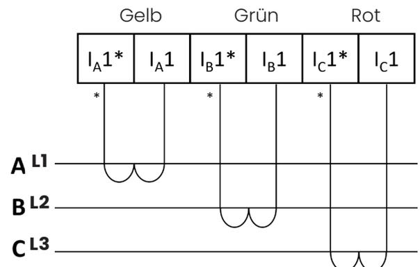
3. Einen der drei Klappstromwandler an die Phase (z.B. L1) des Plug-in Speichers hinter dem Sicherungsautomaten anbringen (Auf richtige Farbzuordnung achten! Phase L1 (gelb), L2 (grün) oder L3 (rot)). Verbindung zu CH2 herstellen
