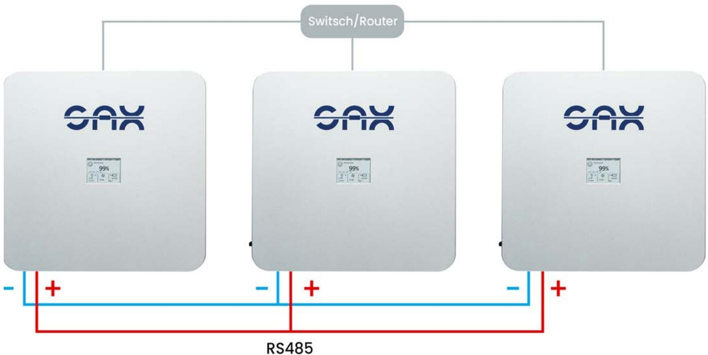
1. RS485-Verbindung zwischen den Speichern herstellen. Dazu die Pole „+“ und „-“ der Speicher in Parallelschaltung über Klemmen verbinden.
