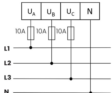
1. Kabel für Spannungsmessung an jeder Phase am Klemmblock anschließen UA, UB, UC und N. Schrauben am Klemmblock festdrehen.
